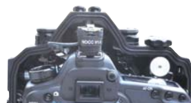
カメラのアクセサリシューに Nexus 光コネクタCを接続
